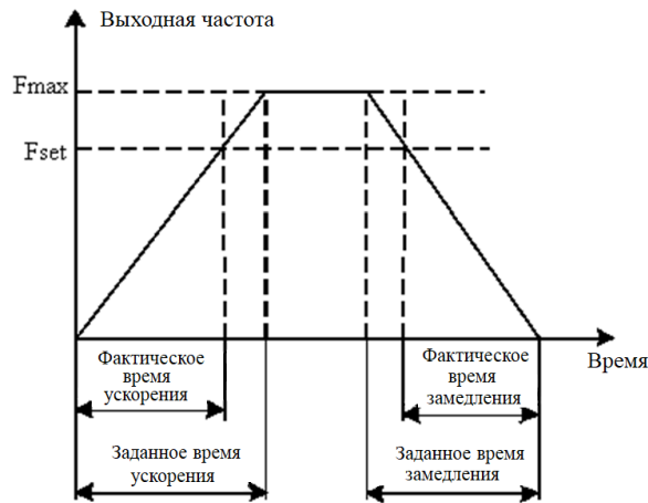
Рис. 6-2 Схема времени ускорения/замедления
