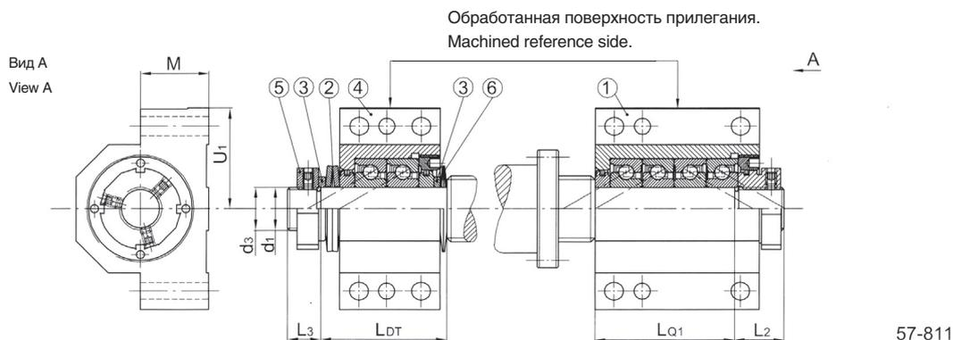
Шариковая резьбовая передача с опорами с обеих сторон с BSPB-M ... Q + BSPB ... D ... DT+PLS при помощи фиксируемых гаек может быть закреплена и смещена
