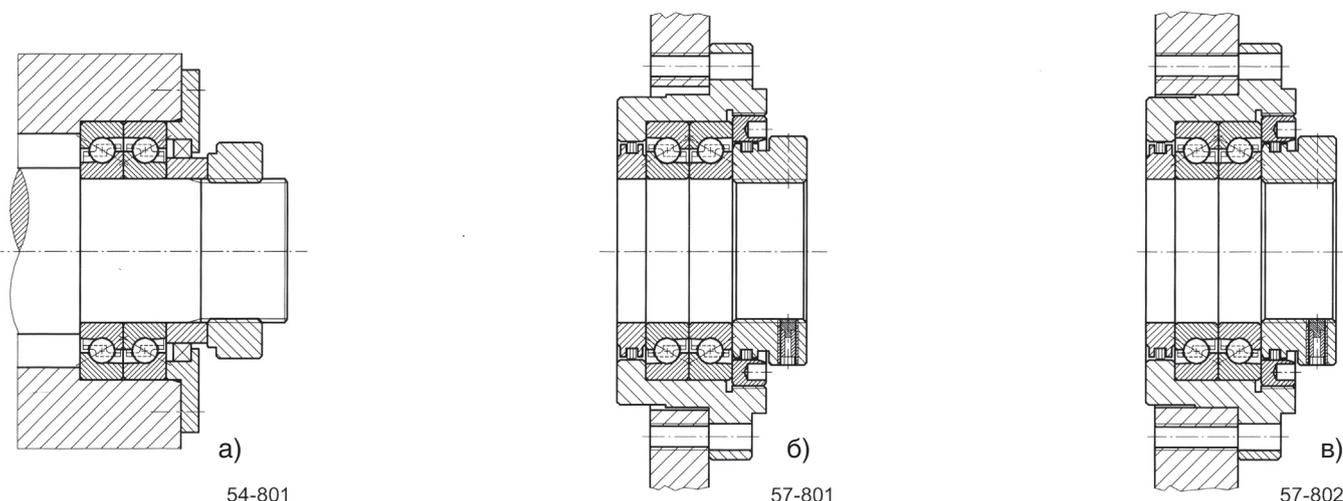
Рис. 4.1: Разработка удобных для изготовления и монтажа подшипниковых узлов шарико-винтовых пар.
