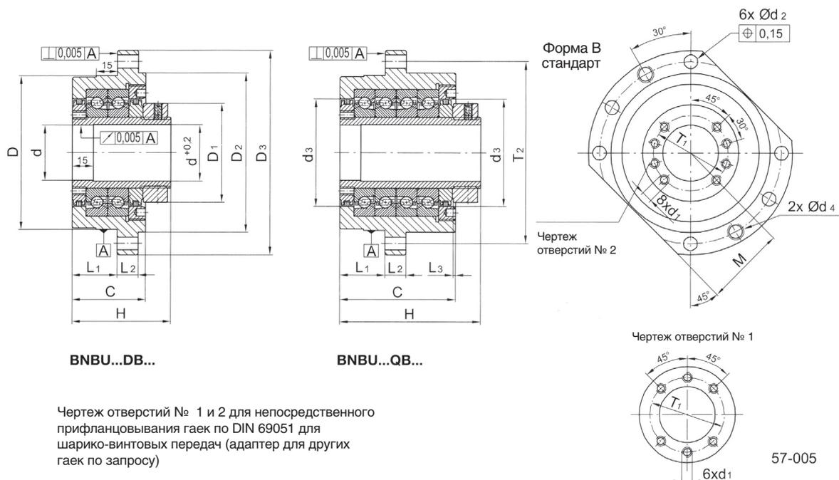
Чертеж отверстий № 1 и 2 для непосредственного прифланцевывания гаек по DIN 69051 для шарико-винтовых передач (адаптер для других гаек по запросу)
