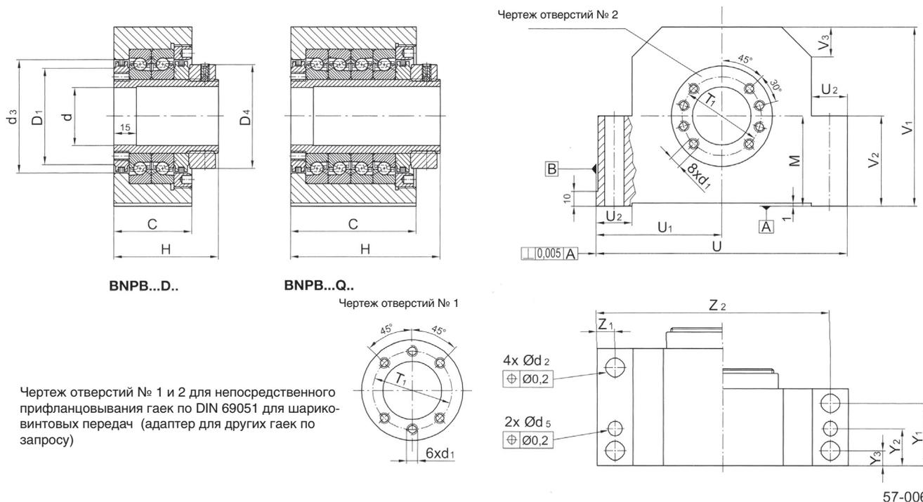
Чертеж отверстий № 1 и 2 для непосредственного прифланцовывания гаек по DIN 69051 для шарико-винтовых передач (адаптер для других гаек по запросу)
