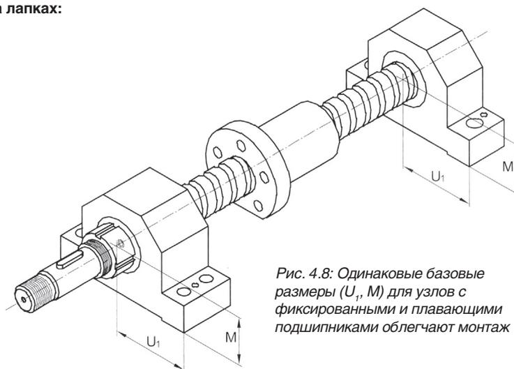
Рис. 4.8: Одинаковые базовые размеры (U<sub>1</sub>, M) для узлов с фиксированными и плавающими подшипниками облегчают монтаж
