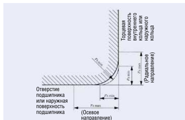
Рис. 12. Допустимые значения размеров фаски
